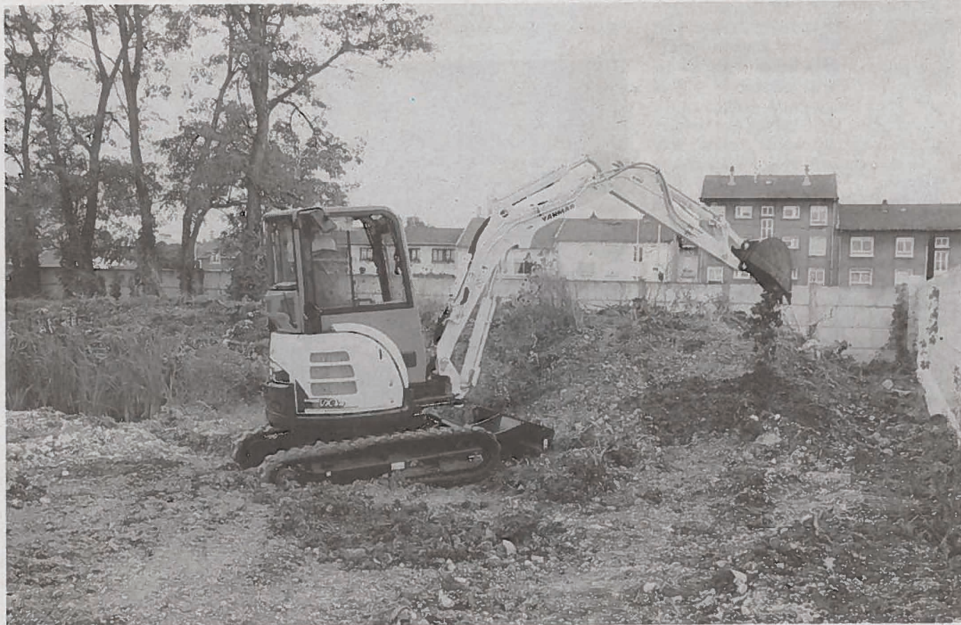
Der Universal Vi038 hat die Leistung einer 4-t-Maschine und liegt zwischen dem Vi033U und dem Vi050U.
