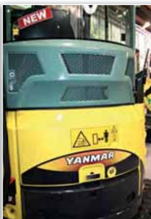
L'Universal Vi033 è un "vero" zero tail swing: né i cofani né i contrappesi sporgono rispetto al sottocarro
