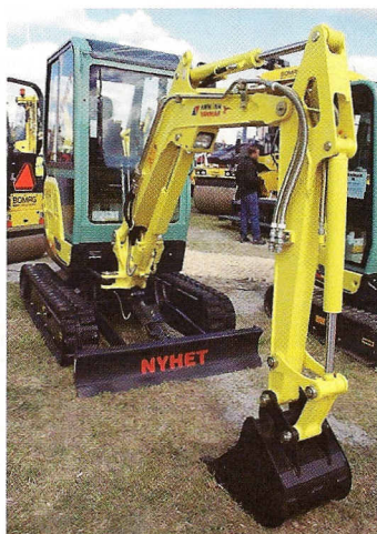
YANMAR SV20 väger 2 260 kilo och har en grävkraft på 1 900 kilo i skopan.
