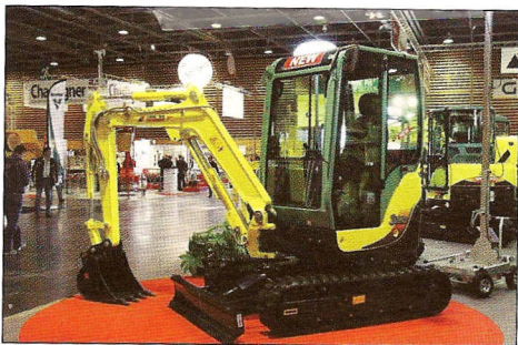
Minigraveren SV20 er en ny modell fra Ammann Yanmar. Den rundt 2,2 tonn tunge minigraveren har en Yanmar-motor på 13,4 kW.
